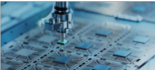
▲ 고정밀 조립 라인에서는 부품의 재질과 크기가 작고 깨지기 쉬운 경우가 많다. Z축 모션의 힘 제어는 제품 수율과 생산성을 향상시키는 핵심 요소이다.
